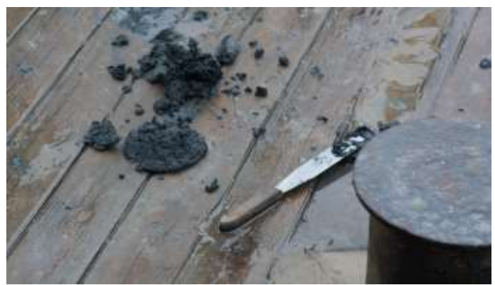
Отбор проб грунтовой трубкой. Глинистый ил послеледникового периода Балтийского моря, возраст до 10–12 тыс. лет.
