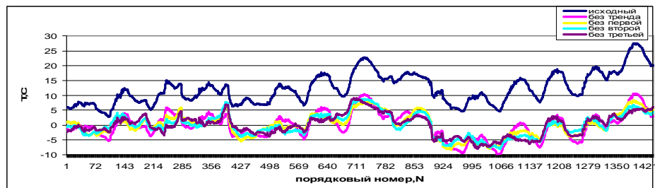
Рисунок 15. Исходный фрагмент временного ряда приземной температуры воздуха, измеренной за 14 дней мая 2012 года в Санкт-Петербурге, и его трансформация в процессе исключения временного тренда и трех периодических составляющих
