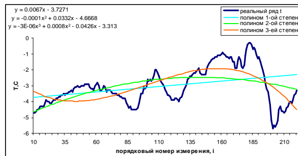
Рисунок 6. Результаты аппроксимации временного тренда полиномами первой, второй и третьей степеней для фрагмента временного ряда приземной температуры, измеренной с дискретностью 15 мин
