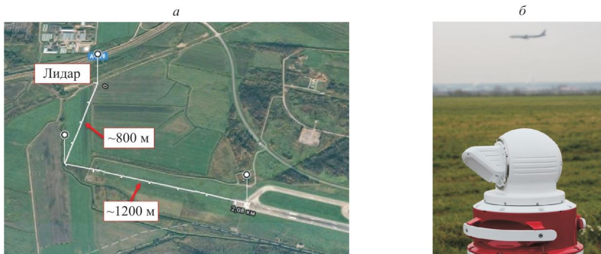
Рисунок 4.18 Схема расположения когерентного доплеровского лидара ( б ) относительно ВПП ( а ) и его внешний вид.
