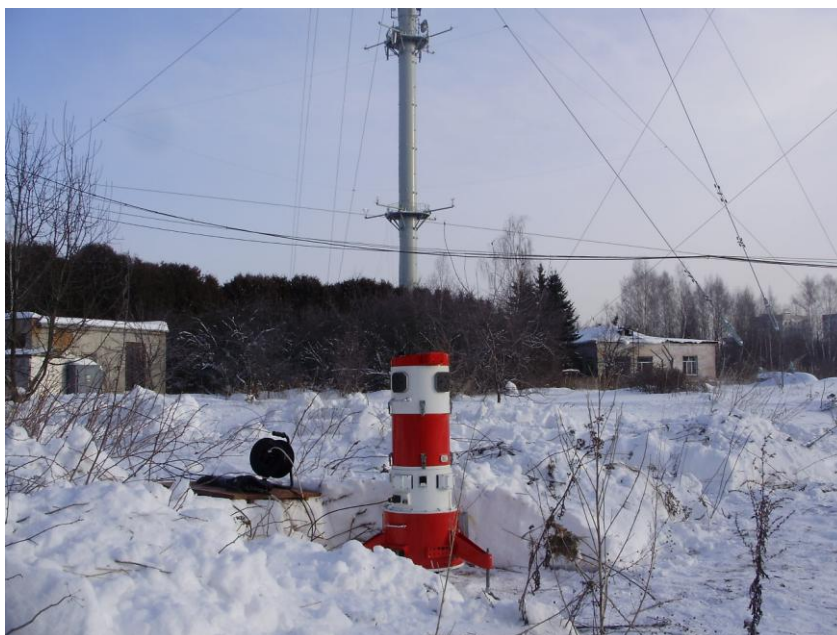
Рисунок 4.10 - Фотография профилометра ПЛВ-300 и мачты ВММ-310 на полигоне ФГБУ «НПО «Тайфун»
