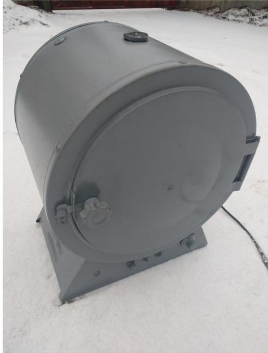
Рисунок 3 – внешний вид сушильного шкафа
