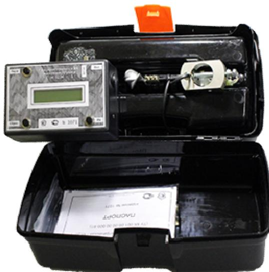
Рисунок 2 Внешний вид микровертушки
