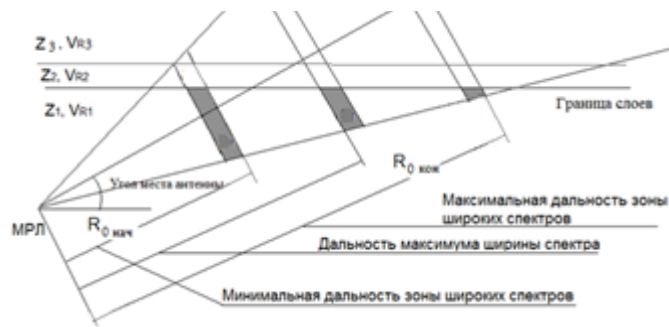
Рисунок 3.1 - Схема формирования вертикального распределения ширины спектра принимаемого сигнала
