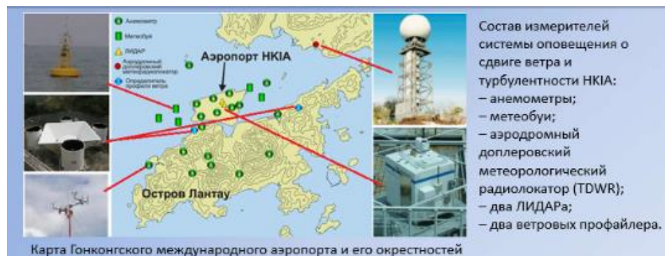
Рисунок 2.1 - Схема расположения метеорологического оборудования в аэропорте Гонконга
