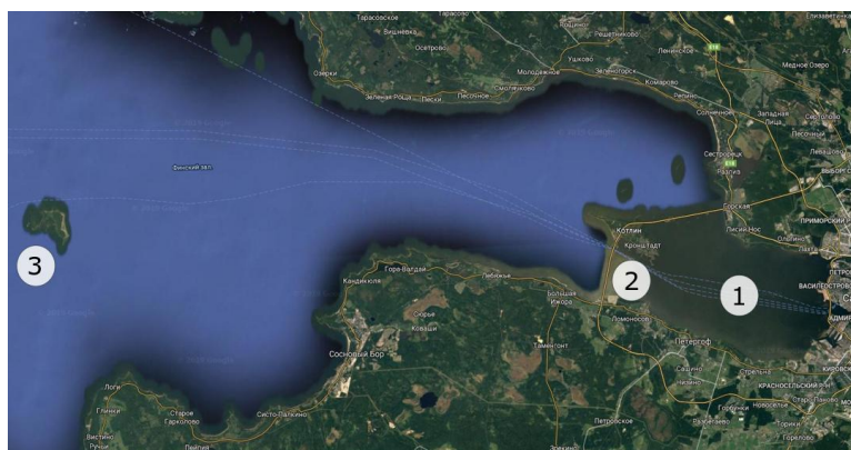
Рисунок 3.2 – Схема расположения основных элементов при строительстве аванпорта «Бронка»: 1 – Невская губа; 2 – Ломоносовская отмель; 3 – месторождение песка о. Сескар
