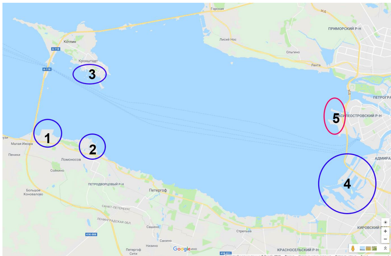
Рисунок 2.3 – Схема расположения объектов морского порта «Большой порт Санкт-Петербург», где красным цветом обозначен пассажирский порт, синим – грузовые; 1 – аванпорт «Бронка»; 2 – порт г. Ломоносова; 3 – порт г. Кронштадт; 4 – основная часть порта «Большой порт Санкт-Петербург»; 5 – пассажирский порт
