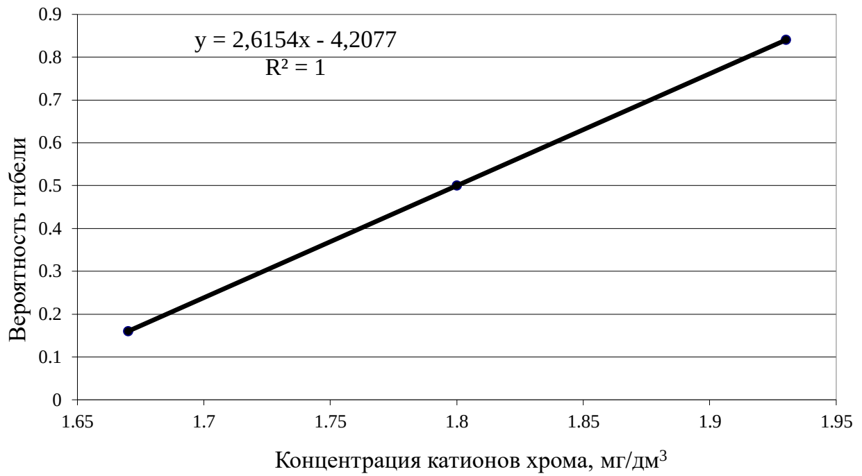
Рисунок 2.7 – Соотношение между вероятностью гибели дафний и концентрацией катионов хрома ( \text{Cr}^{6+} ) при экспозиции 48 часов
