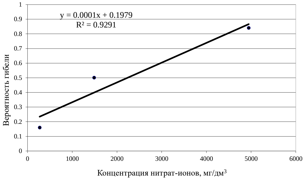
Рисунок 2.19 – Соотношение между вероятностью гибели дафний и концентрацией нитрат-ионов ( \text{NO}_3^- ) при экспозиции 48 часов
