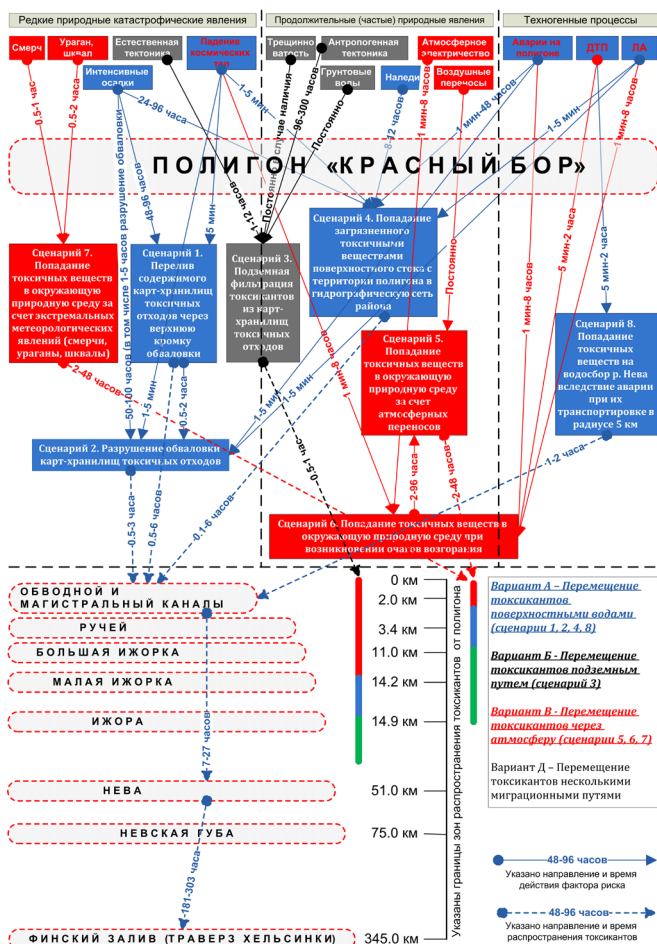
Рис. 1 – Графическая схема основных сценариев возможного развития чрезвычайных (аварийных) ситуаций на полигоне «Красный Бор»
