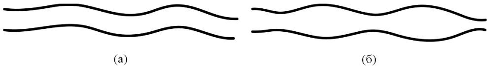
Рис. 3. Типы волн, возмущающие жидкую пленку.
