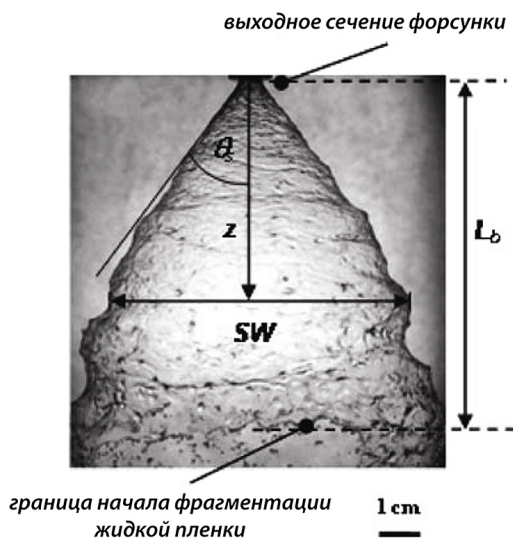
Рис. 6. Параметры, характеризующие распадающуюся жидкую пленку [10].
