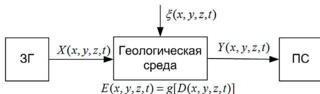
Рис. 2. Система геодинамического контроля как радиотехническая система.
