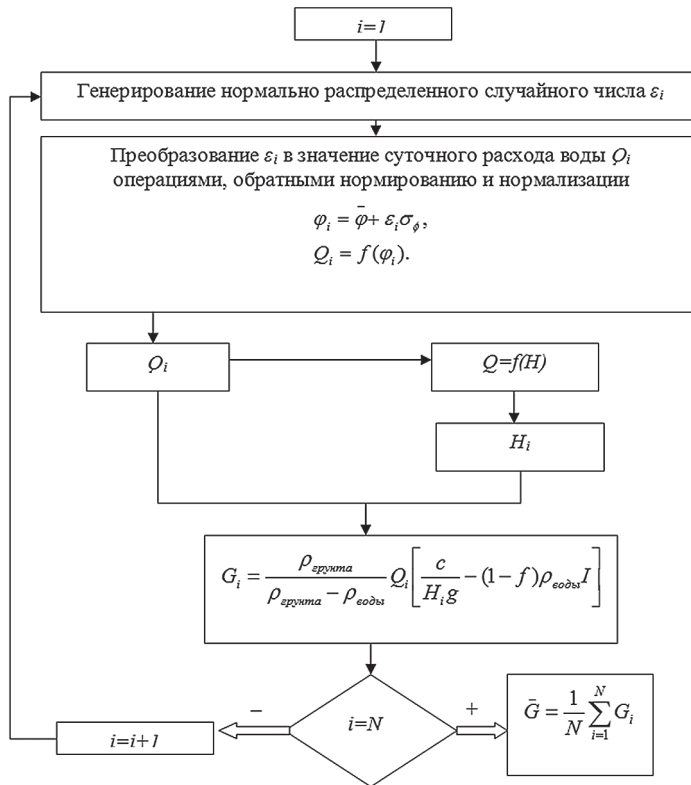
Рис. 1. Структура моделирования расхода наносов (где \bar{\varphi} и \bar{G} — среднегодовые значения нормализованных расходов воды, м 3 /с и наносов, кг/с; G_{\varphi} — среднее квадратичное отклонение нормализованных суточных расходов воды; N — длина генерируемого ряда; i — индекс)
