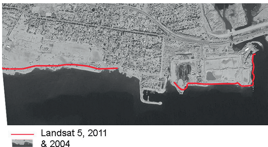
Рис. 5. Состояние береговой полосы на участке территории строительства МК ЛЦ по результатам спутниковой съемки 2004 и 2011 г. (спутник Landsat; материалы предоставлены ведущим специалистом НИИ Космоаналитических Методов / НИИ КАМ к.г.н. Л.Л. Сухачевой)
