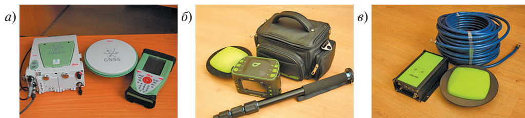
Рис. 1. Комплекты навигационной аппаратуры, использованные в эксперименте: а — геодезический приемник Viva GS10 (Leica) с антенной (ООО «Навгеоком»); б — геодезический приемник Triumph V.S. (Javad) с антенной и мачтой; в — геодезический приемник Sigma (Javad) с антенной и бухтой кабеля
