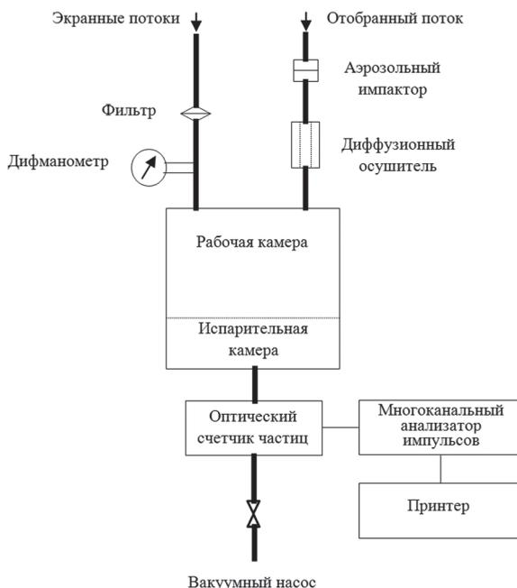
Рис. 2. Блок-схема диффузионной камеры непрерывного потока с вертикальной ориентацией потока [30]
