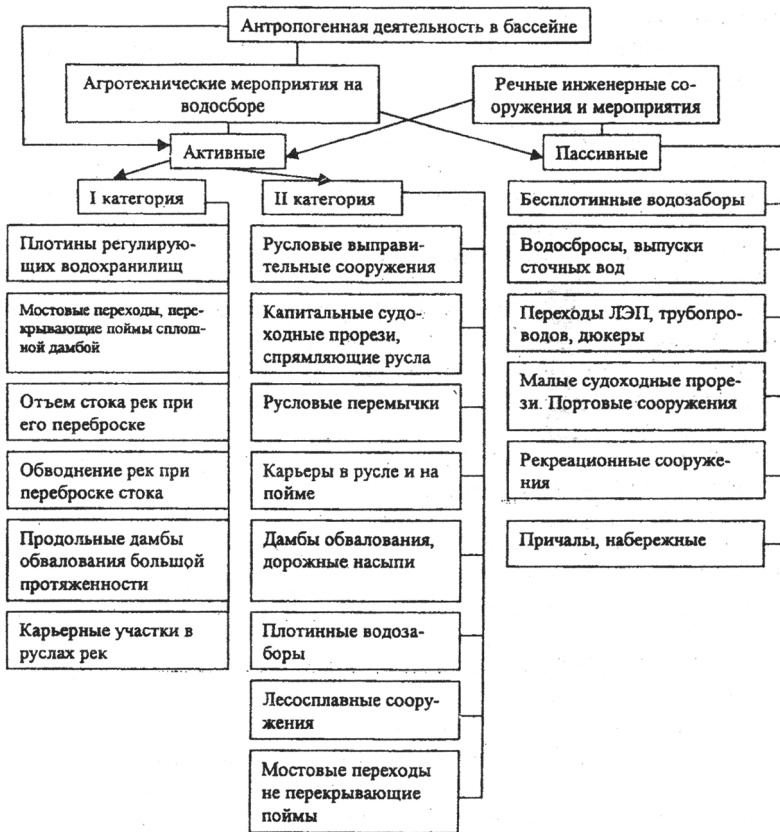
Рис. 1. Типизация речных инженерных сооружений по их воздействию на русловые и пойменные процессы (по Б.Ф. Снисенко)
