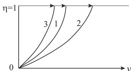
Рис. 3. Эпюры скорости на вертикали при глубине реки  $H$  и трех положениях водной поверхности: 1 — при равномерном; 2 — ускоренном; 3 — замедленном движениях потока жидкости;  $\eta$  — относительная глубина потока
