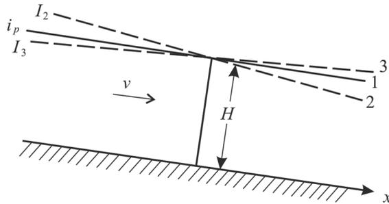
Рис. 1. Продольное сечение водного потока в реке. Водная поверхность соответственно: 1 — при равномерном; 2 — ускоренном; 3 — замедленном движениях потока жидкости
