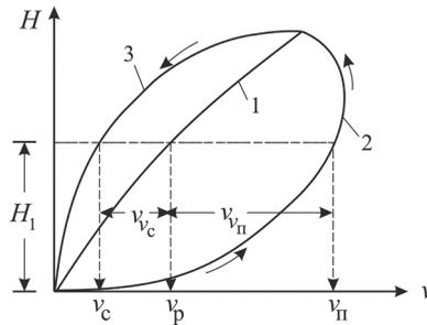
Рис. 2. Схематическое изображение кривых средней скорости потока в сечении реки: 1 — при равномерном; 2 — ускоренном; 3 — замедленном движениях потока жидкости
