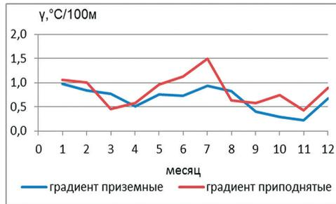
Рис. 9. Температурный градиент в приземном и приподнятом инверсионном слое
