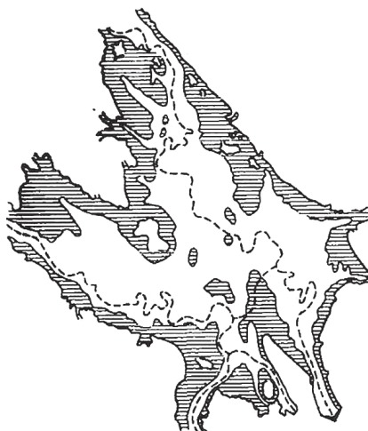
Рис. 2. Схема мелководий Рыбинского водохранилища [1]. Зона временного затопления заштрихована. Руслу рек показаны пунктирными линиями
