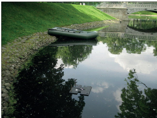
Рис. 1. Ультразвуковая установка SS-400 в контрольной части пруда Михайловского сада
