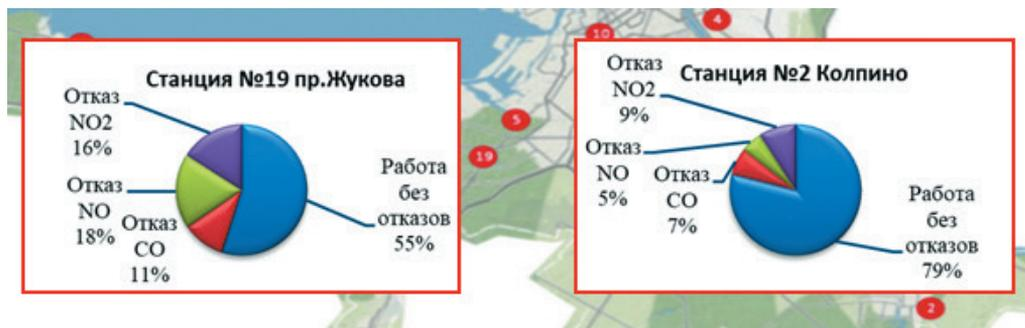
Рис. 3. Диаграммы, отражающие периоды безотказной работы и отказов датчиков ЗВ.
