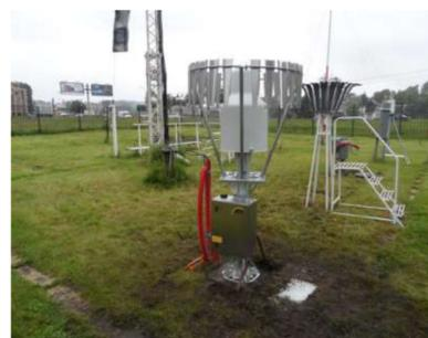
Автоматический осадкомер OTT Pluvio2, установленный на пилотном полигоне
