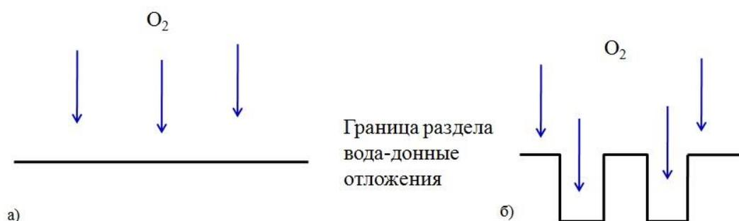
Рис. 4. Площадь окисленного слоя донных отложений и глубина проникновения кислорода при отсутствии (а) и наличии (б) зарывающихся организмов
