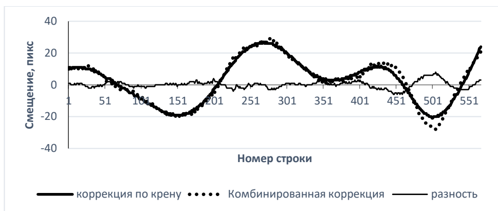
Рис.3.13 - Результаты геометрической коррекции данных экспериментальной съемки для задачи поиска техногенного мусора в виде зависимости смещения строк снимка в пикселях от номера строки
