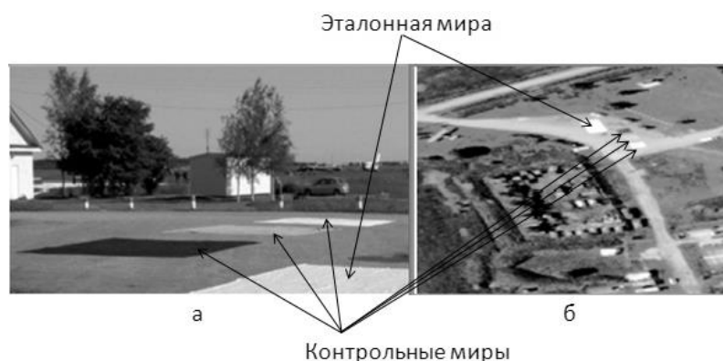
Рис.2.7 - Расположение тестовых мир на асфальте (а) и фрагмент авиационного кадра ВСС на средней спектральной линии - (б).
