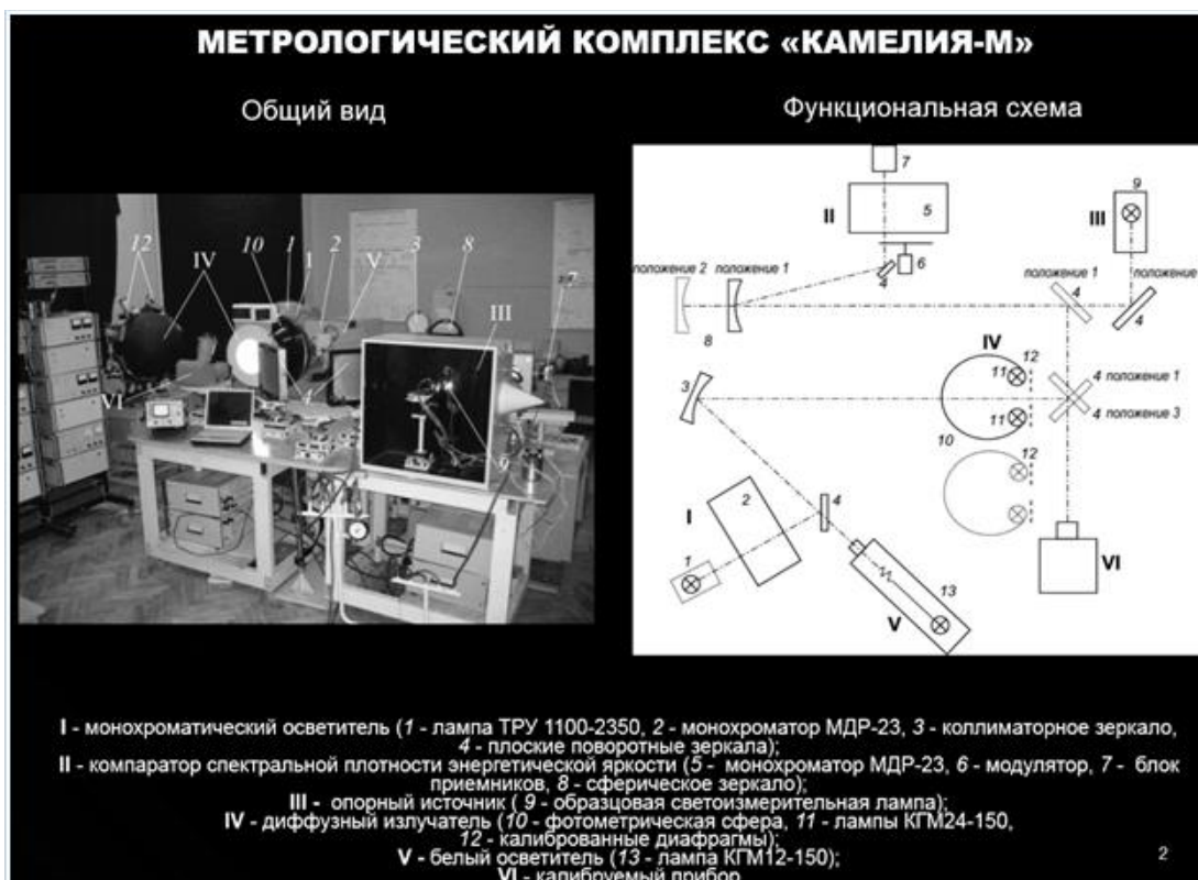
Рис.1.6 - Внешний вид и принципиальная схема измерительного комплекса оценки параметров аппаратуры ВСС
