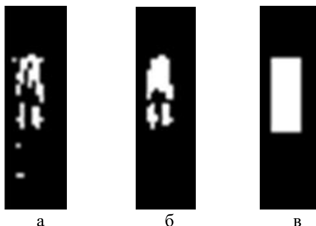
Рис.4.8 – Образы искомого объекта, полученные в ходе распознавания на основе дискриминанта (4.4): а – по исходным данным, б – после фильтрации шумов и коррекции полосовых искажений, в – истинное положение искомого объекта
