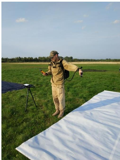
Рис.1.5 – Наземные измерения спектральных сигнатур объектов
