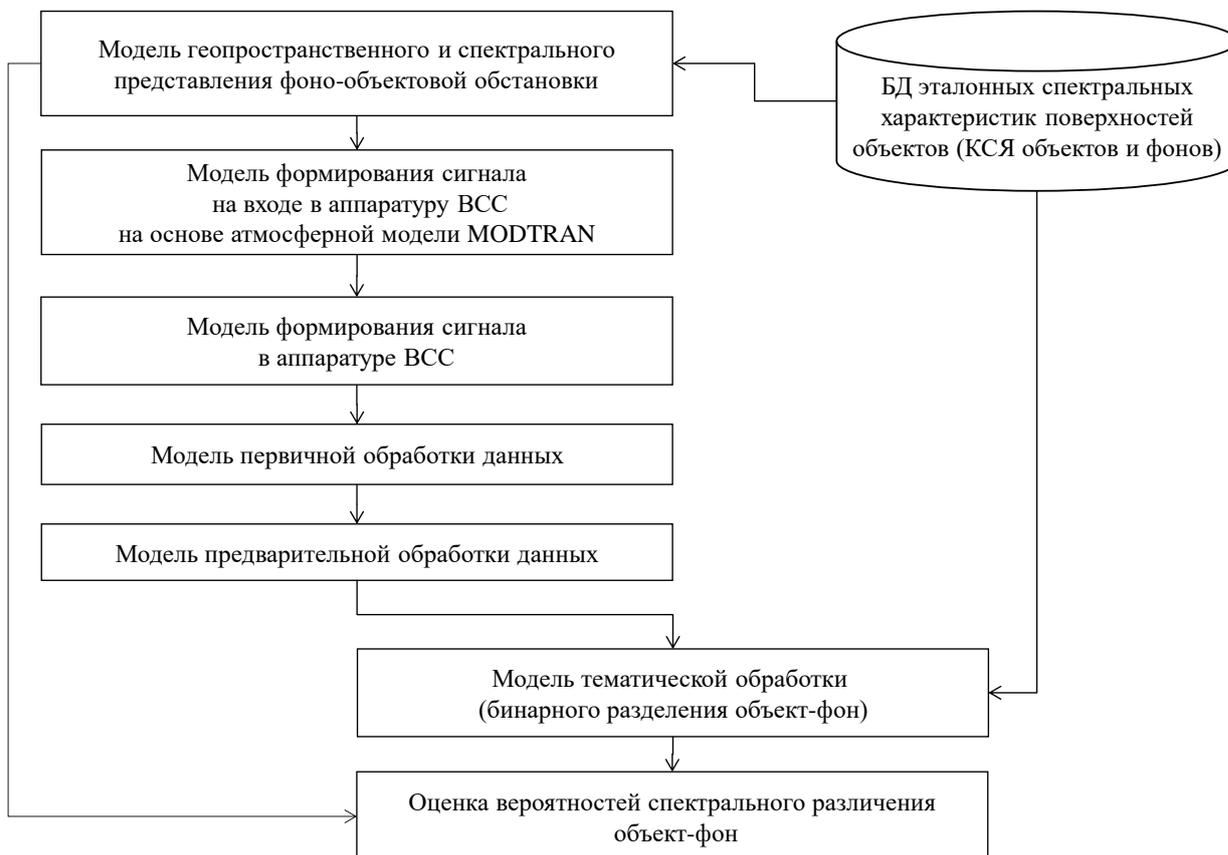
Рис.4.1 – Структурно-функциональная схема имитационной модели
