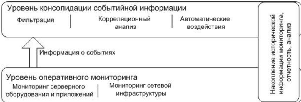
Рис.2. Логическую архитектуру системы мониторинга.
