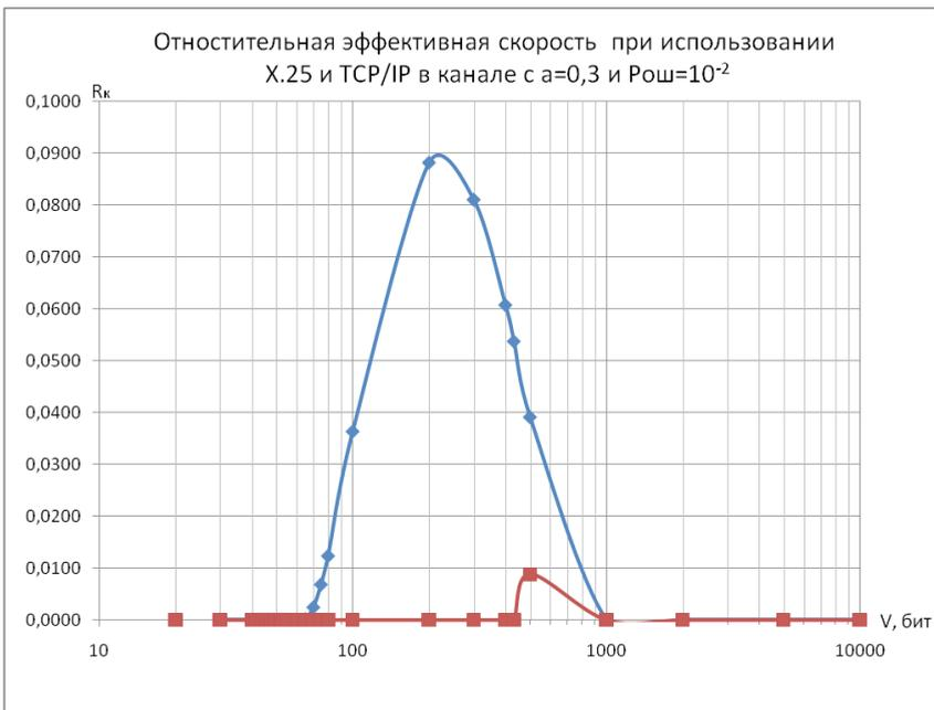
Рис.2. Относительная эффективная скорость в каналах с  $\alpha=0,3$  и  $Roш=10^{-2}$
