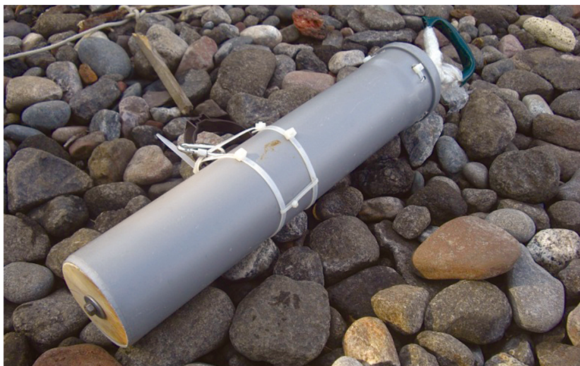
Рис. 4. Бентосный пробоотборник оригинальной конструкции
