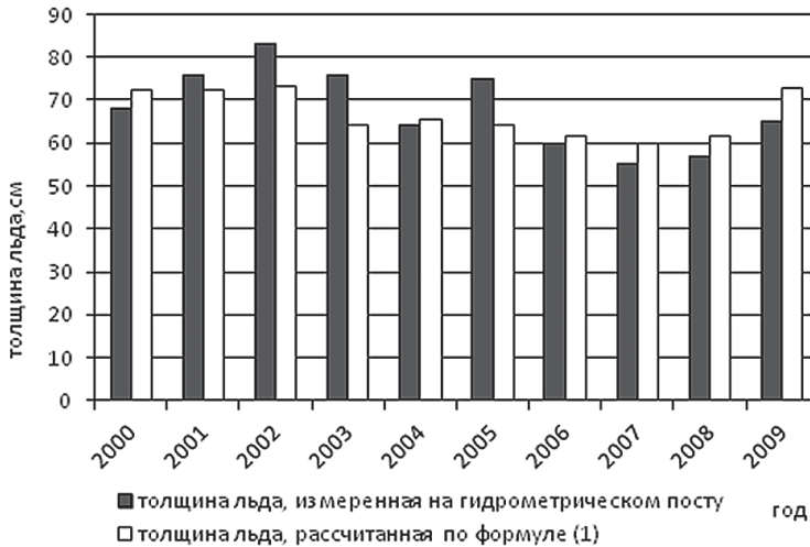
Рис. 3. Совмещенный график измеренной и рассчитанной толщины льда на дату вскрытия р. Печора — с. Усть-Цильма.
