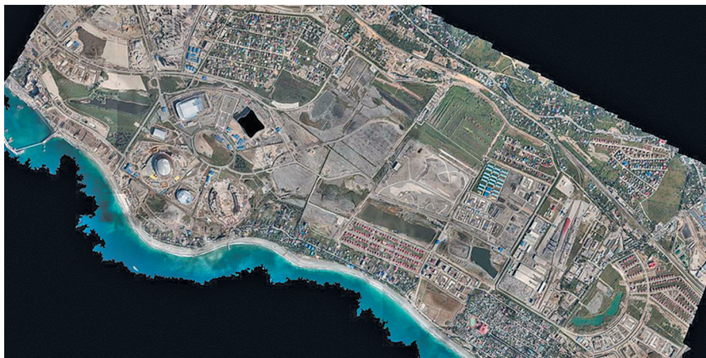
Рис. 4. Контроль строительства олимпийских объектов в Сочи — картографическая съемка (сшивка из 40 кадров при разрешении 22 МП) строительных объектов в прибрежной полосе сделанная с высота 450 м
