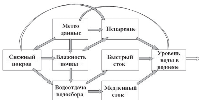
Рис. 3. Схема модели ILHM, описывающей формирование стока на водосборе и динамику уровня водоема
