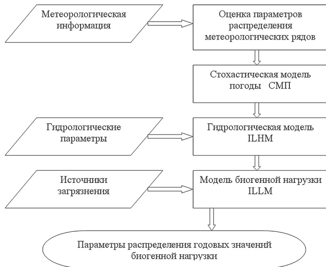
Рис. 1. Схема ДС моделирования стока и биогенной нагрузки
