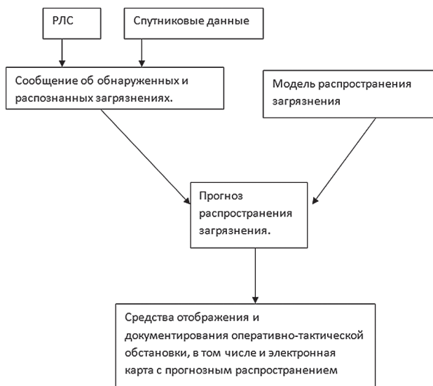
Рис. 1. Обобщенная схема получения, передачи и обработки информации в зоне ответственности
