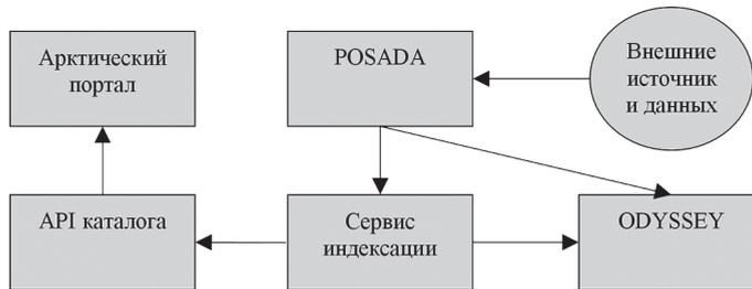
Рис. 16 . Инфраструктура системы распространения и анализа спутниковых данных
