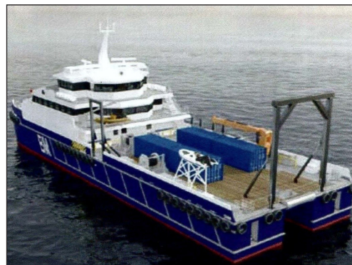
Рис. 3. Судно для обеспечения водолазных и подводно-технических работ, оптимальное для решения задач, связанных с геоэкологическими исследованиями
