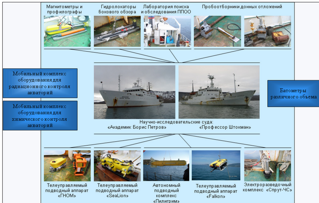
Рис. 2. Состав модулей комплексной измерительной системы, применяемой для геоэкологических исследований на море
