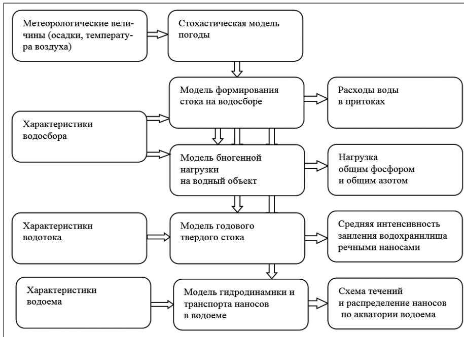
Рис. 1. Схема ДС моделирующей системы «погода – сток – биогенная нагрузка – речные наносы – заиление»
